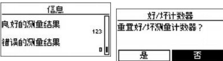
超过限值时，坏计数器增加，低于限值时，好计数器增加。该计数器可用于评估软化系统的功能。坏测量值应明显少于好测量值。计数器可在菜单中重置。
